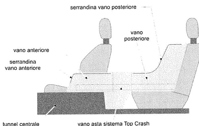
Figura 2: Schema di massima del mobile contenitore centrale
