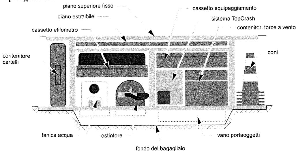
Figura 3: Schema di massima del mobile contenitore posteriore
